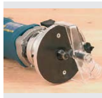
Lagerbremse für ein Ansetzen des Fräses ohne Bremsspuren
